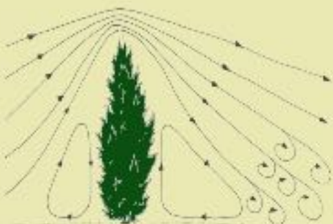
Brise-vent imperméable : le vent butte contre la haie et gagne en intensité en passant par dessus.
